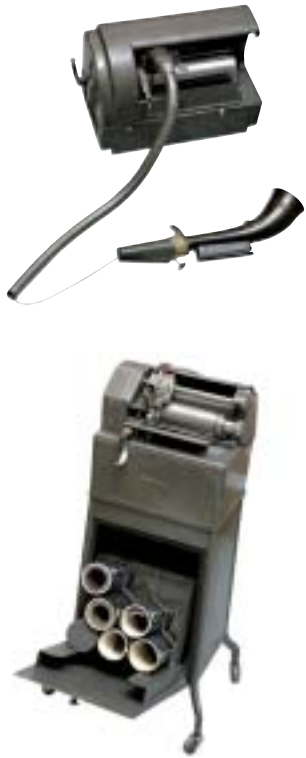
MCB beschikt over een ouderwetse dictafoon waarmee brieven worden ingesproken. Het geluid wordt vervolgens op wasrollen gekerfd die via een bijbehorend apparaatje worden schoongeveegd.
